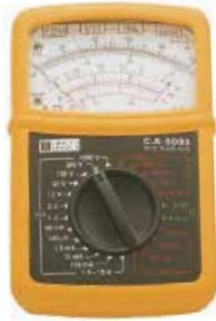
Analoge Multimeter sind Zeigerinstrumente, welche die Messung verschiedener Grössen wie Spannung, Strom und Widerstand mit einem Gerät erlauben.
