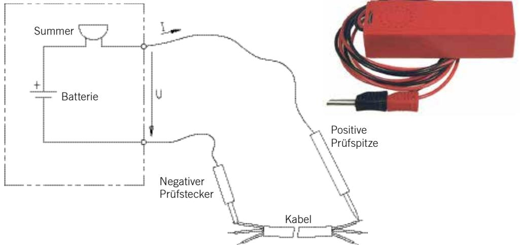
Durchgangsprüfer enthalten eine Batterie und einen Summer. Wird der Stromkreis durch das zu prüfende Objekt geschlossen, so fließt der Prüfstrom durch das Prüfobjekt.
