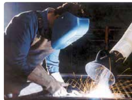
Fest installierte Absauganlage
